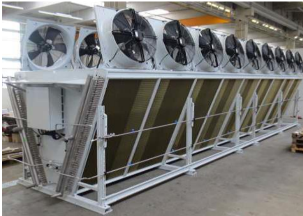
Abb. 1: Kondensatoren mit 18 Ventilatoren, in Wetzikon sind es zwei Apparate mit je acht Ventilatoren
